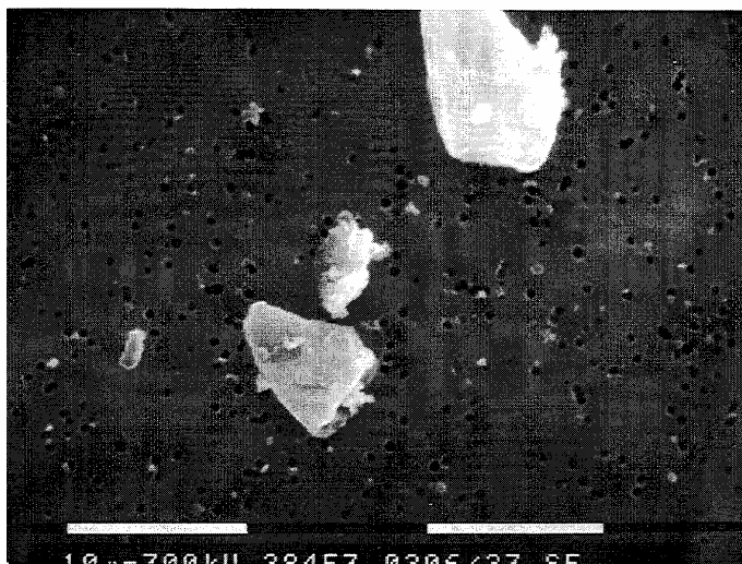
Bild 2 Förekomst av mikrobiologiskt material omkring ca 10 µm i tilluft. Bild tagen med svepelektronmikroskop (upplösning: 10 µm)
